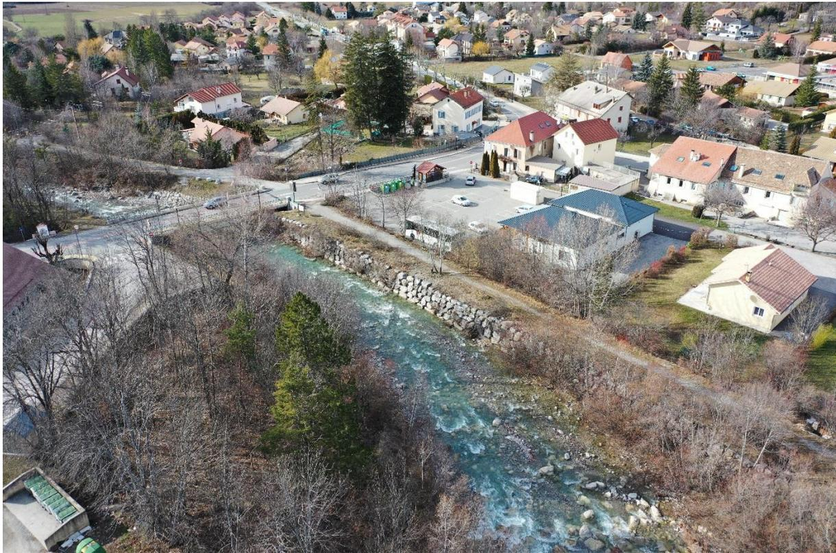
**Figure 7: Protection des berges en enrochement (La Roche des Arnauds, février 2020, AMETEN)**
